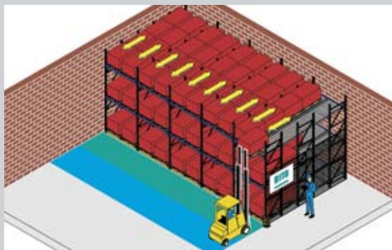
Spádový PUSH BACK regál - LIFO princíp
