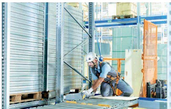
3. Ruotare lateralmente l'attivatore del separatore di carico FlowStop e bloccarlo con il dispositivo di bloccaggio
