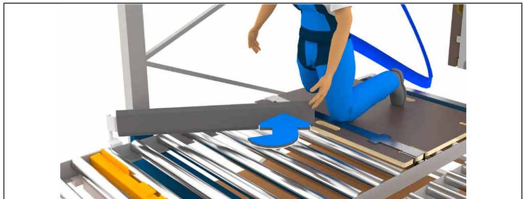
Abbildung 24: FlowStop-Fahne zur Seite schwenken
