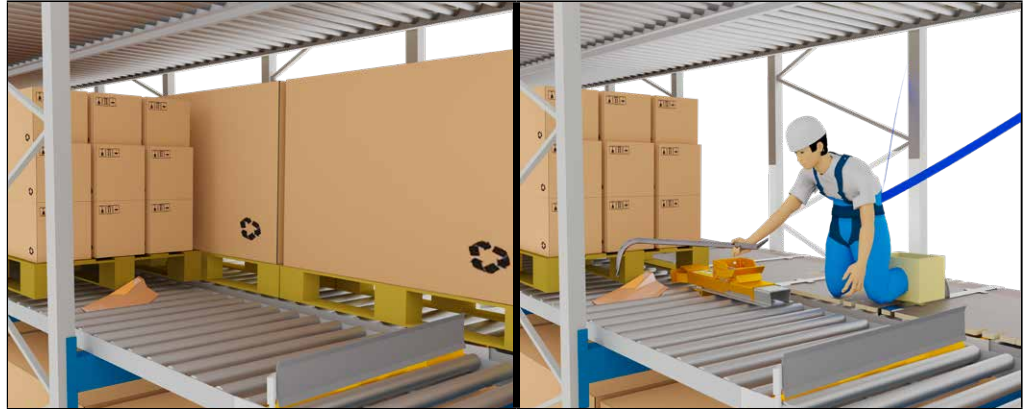
Abbildung 7: Entfernen von Gegenständen / Verpackungsresten im Kanal
