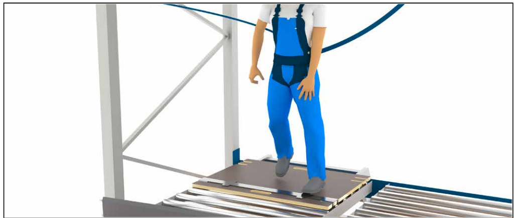
Abbildung 23: Austritt aus der Arbeitsbühne auf das Brett zur Begebarkeit
