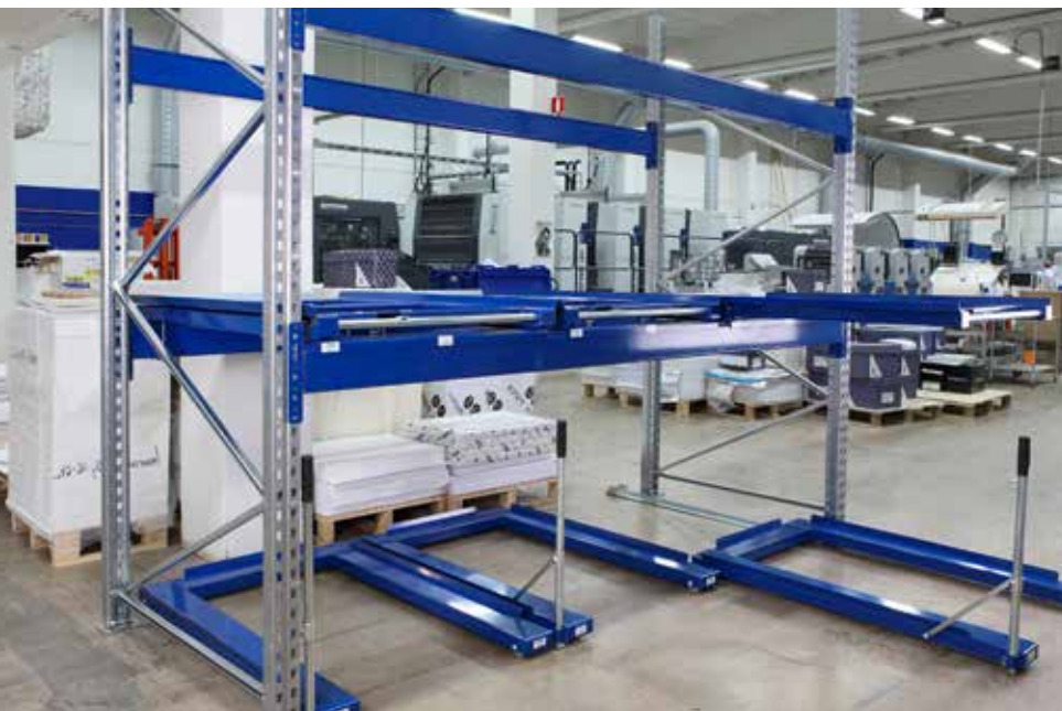
Système de tiroirs à palette au niveau du sol et des lisses
