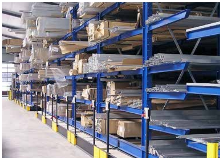
Rayonnages cantilever mobiles, stockage de charges longues
