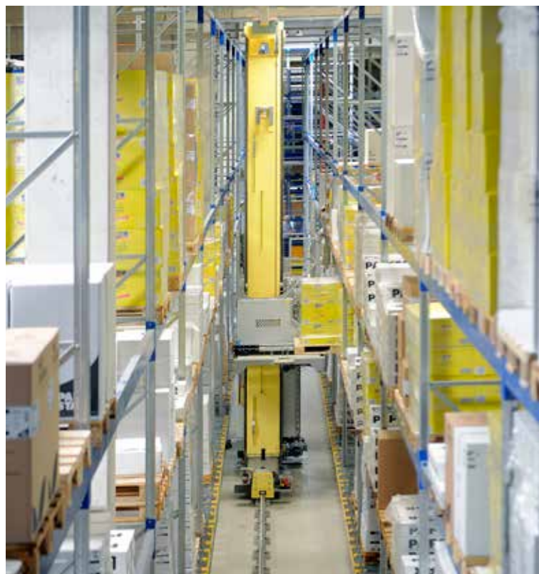
Papstar, entreposage de palettes Au niveau du sol, les palettes sont stockées dans des couloirs dynamiques pour la mise à disposition dans la zone de préparation des commandes.
