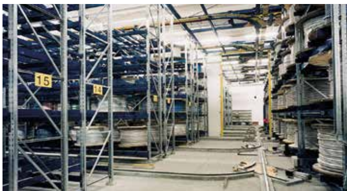
Manutention par transtockeurs à changement d'allées.
