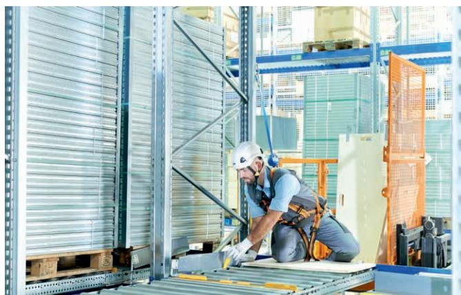
3. Faites pivoter l'aileron du séparateur de palettes FlowStop sur le côté et sécurisez-le à l'aide du dispositif de blocage.
