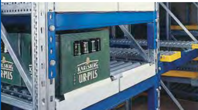
Beschickungsseite mit Festanschlag als Rückschubsi- cherung – abgeschragt zur leichteren Beschickung
