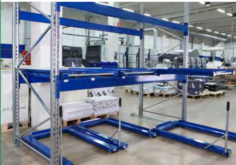
Auszugsvorrichtung am Boden und auf Traversen
