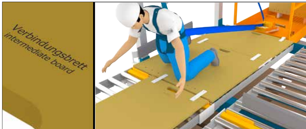
På billedet 35: Forbindelse af forbindelsesbrættet til passagebrættet
