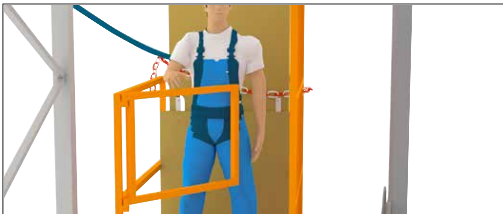
På billedet 24: Åbning af arbejdsplatformens låge
