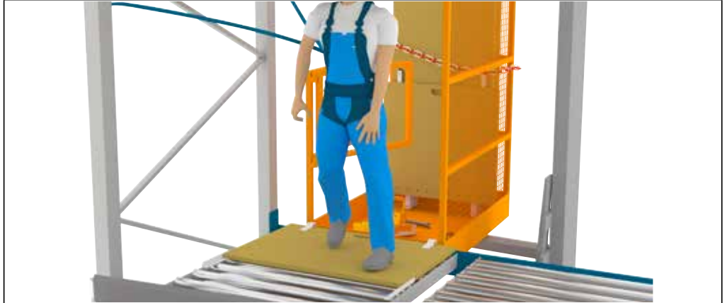
På billedet 26: Udtræden fra arbejdsplatformen til startbrættet for at kunne gå ind i nabokanalen
