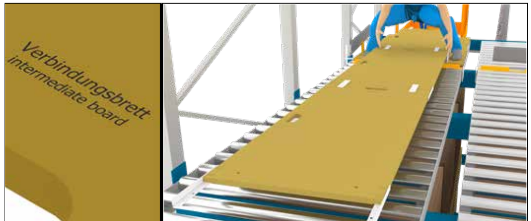
På billedet 33: Udlægning af forbindelsesplader
