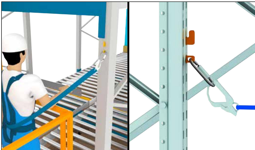
På billedet 23: Fastgørelse til stolpe ved hjælp af BITO-easyHook
