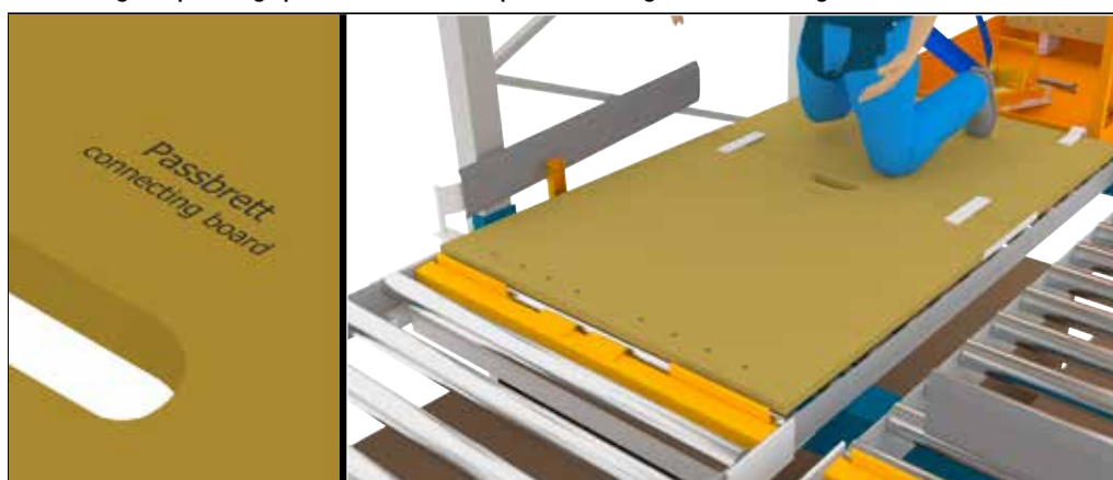
På billedet 30: Forbindelse af passagebrættet til startbrættet
