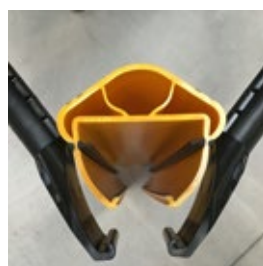
Toolset voor aanbrengen staanderbescherming
