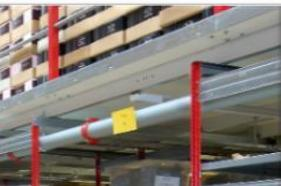
De cette manière, plusieurs niveaux peuvent être utilisés simultanément pour le stockage et la préparation des commandes, par exemple : au niveau inférieur, les articles à forte rotation et la zone de préparation de commande. Au niveau supérieur, le stockage et les articles à faible rotation.
