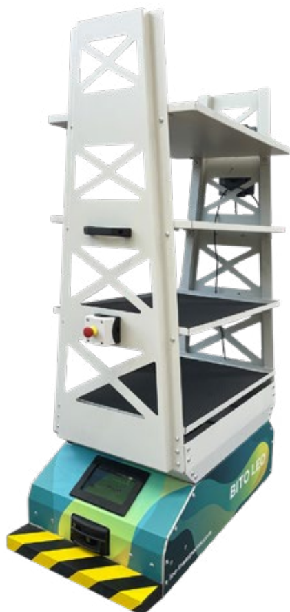
LEO carrier mit einem Regalaufbau und einem montierten Tablet zur Zieleingabe
