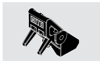
G Sklopný doraz na strane plnenia ako poistka proti spätnému posunu
