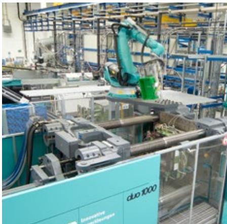
Notre usine pour bacs en plastique est l'une des plus modernes du secteur. Les bacs BITO sont fabriqués sur des machines de moulage par injection très performantes avec une force de fermeture allant jusqu'à 27.000 kN. Dans nos ateliers de finition sur une surface de plus de 600 mètres carrés, nous avons les capacités d'adapter les bacs aux demandes spécifiques de nos clients. La totalité du processus de fabrication est caractérisée par un haut degré d'automatisation et de flexibilité.
