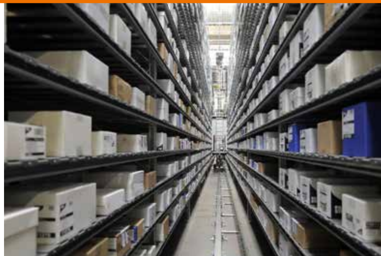
Papstar, entreposage sur des niveaux à segments de platelage
