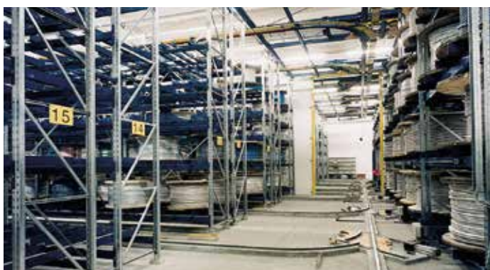
Manutention par transtockeurs à changement d'allées.
