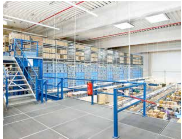
Installation de rayonnages sur 1 étage avec plateforme
