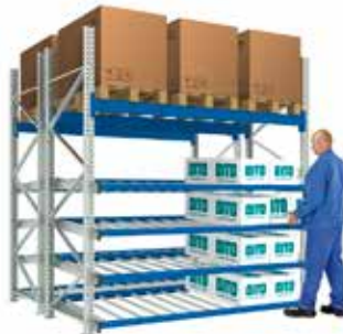
Rayonnage à palettes avec segments de rails à galets pour bacs ou colis (niveaux inclinés, stockage en LIFO)
