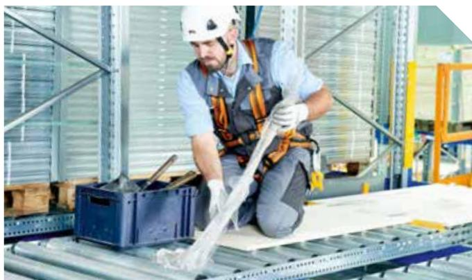
Le Kit d'accès PDS facilite aussi grandement le nettoyage ou l'élimination de la poussière, de la saleté, des liquides et toute autre impureté sur les rouleaux, ainsi que des corps étrangers tels que les films d'emballage. Là encore, l'employé peut accéder directement au couloir dans lequel les planches ont été installées.
