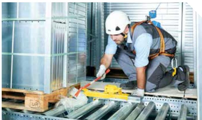
L'accès à la palette défectueuse via le couloir adjacent est facilité grâce au système de planches sécurisées. La palette défectueuse est sécurisée grâce au dispositif « robuste » de blocage de BITO. Ainsi sécurisé par le crochet d'amarrage et le mousqueton Twistlock, l'employé peut analyser et éliminer tout dysfonctionnement en toute sécurité.
