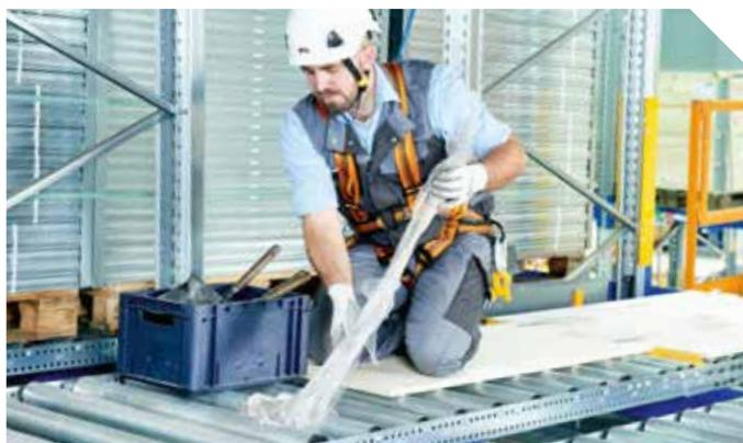
Die Reinigung bzw. die Be- seitigung von Staub, Dreck, Flüssigkeiten und sonstigen Verunreinigungen auf den Rollenbahnen, sowie Fremd- körper wie z. B. Verpackungs- folie wird ebenfalls durch das PDS Access-Kit wesentlich erleichtert. Auch hier steigt der Mitarbeiter direkt in den mit Brettern ausgelegten Kanal ein.
