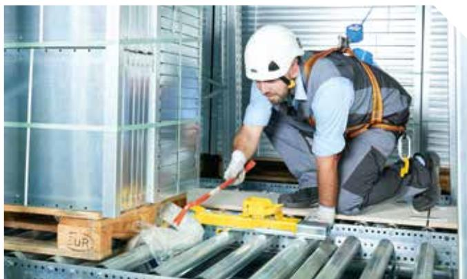
Über den Nachbarkanal, der mit Brettern zur sicheren Begehbarkeit ausgelegt ist, lässt sich die Störpalette leicht erreichen. Mit der BITO Blockievorrichtung robust wird die Störpalette gesichert. Der via Anschlaghaken und Twistlockkarabiner gesicherte Mitarbeiter kann die Störung analysieren und ungefährdet beseitigen.
