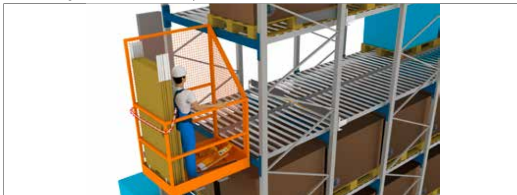
Bild 2: Gaffeltruck utan tillräckligt sidolyft (< 150 mm i varje riktning) och arbetskorg med avspärning inom riskområdet.
