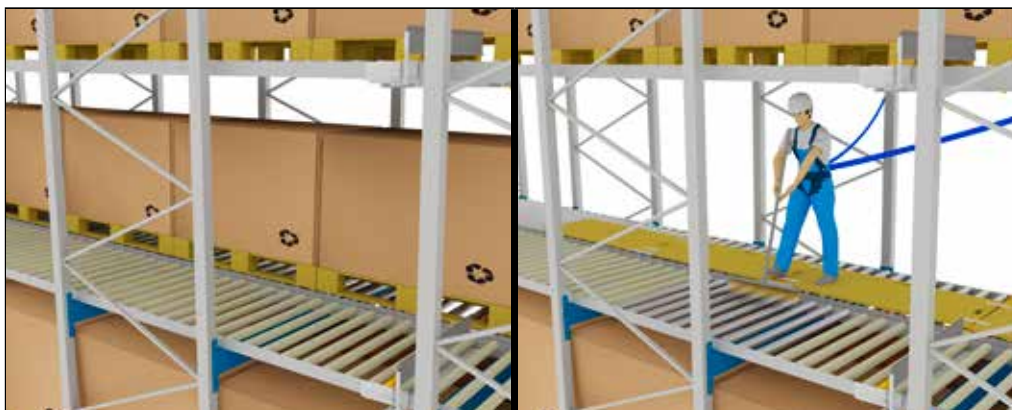
Bild 2: Användningsområde rengöringsarbeten – identifiering av problem och lösning Anvisning: Detaljerad information om användning av Access-kitet vid rengöringsarbeten hittar du på sida 10, fas 2, nr 1–14.
