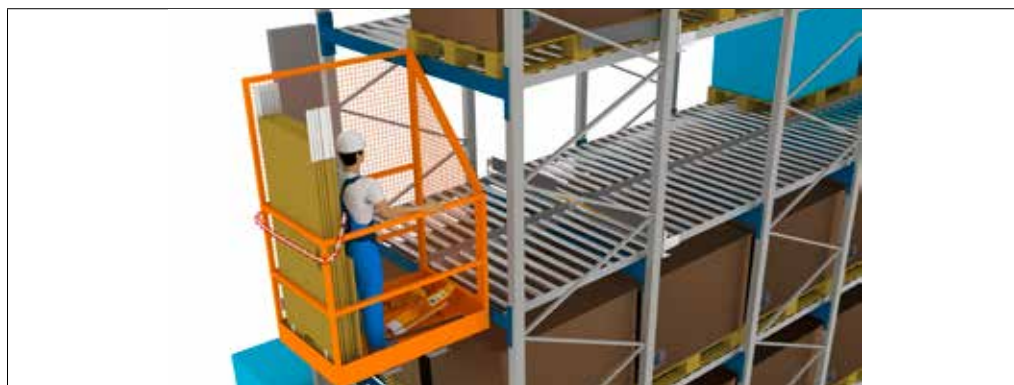
Illustratie 2: Vorkheftruck zonder voldoende zijlift (< 150 mm in elke richting) en werkkorf met hek in de gevarenzone.
