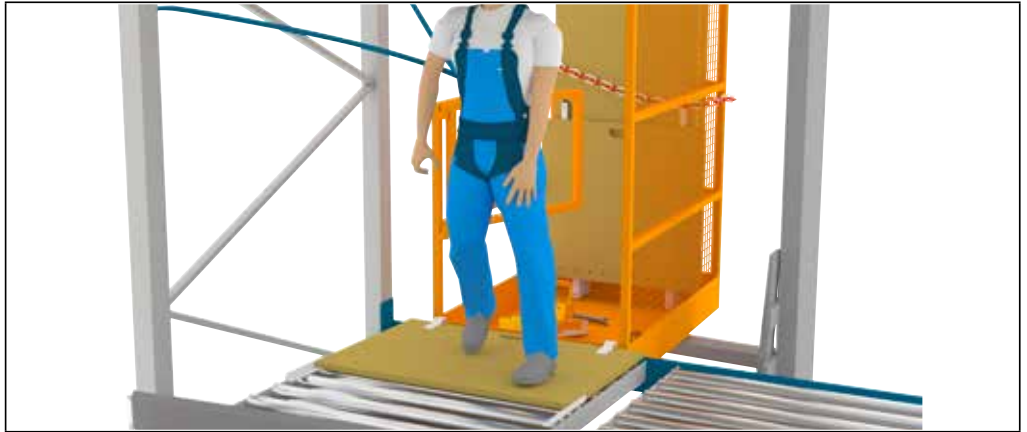
Illustratie 13: Afstappen van het hefplatform naar de startplaat om het kanaal te betreden
