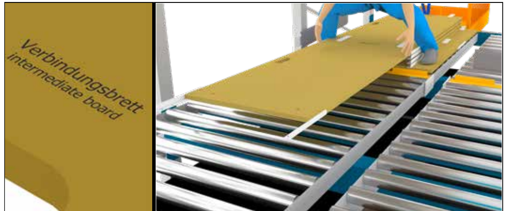
Illustratie 19: Het leggen van de tussenliggende panelen
