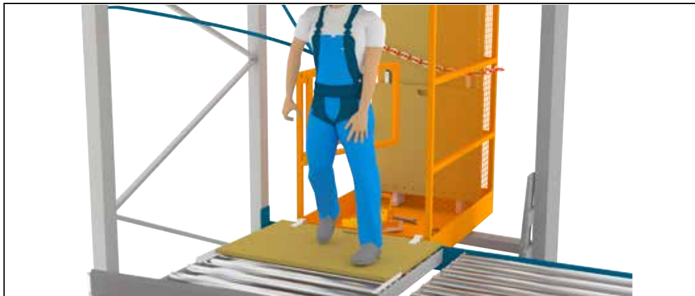
Illustratie 28: Afstappen van het hefwerkplatform naar de startplaat om het aangrenzende kanaal te betreden
