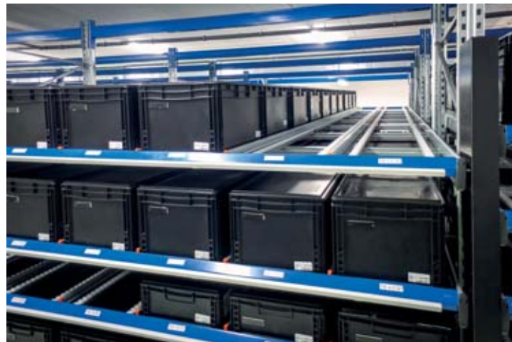
Elektrotechnický priemysel, spádový regál v ESD prevedení s pick to light navádzaním, závod Trstená.
