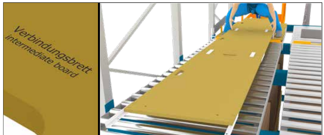
På billedet 35: Udlægning af forbindelsesplader
