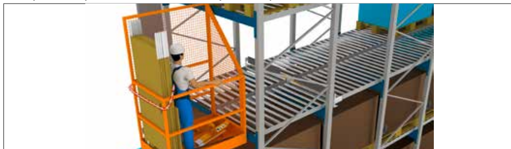
På billedet 41: Gaffeltruck uden tilstrækkeligt sideløft (< 150 mm pr. retning) og arbejds kurv med indhegning i fareområdet
