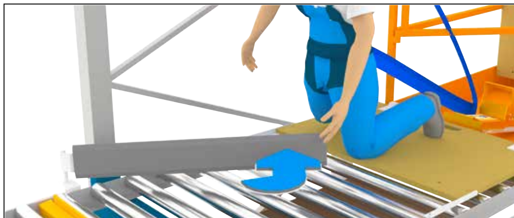
På billedet 29: FlowStop-fane svinges til den ene side
