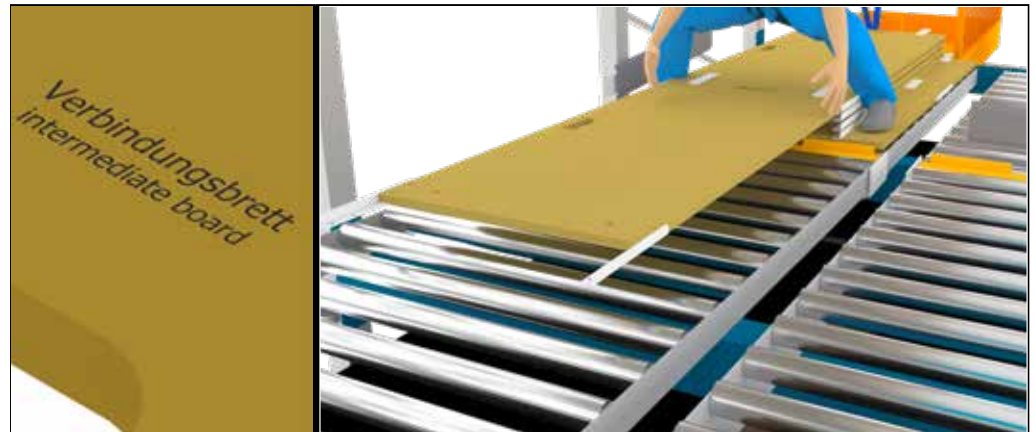
På billedet 34: Udlægning af forbindelsesplader
