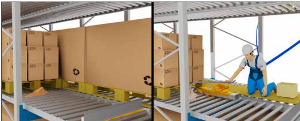
Bild 7: Borttagning av föremål/förpackningsmaterial i kanalen Observera: Detaljerad information om möjliga fel och orsaker samt åtgärdande av fel hittar du i checklistan på sida 38 - 39 och från sida 44 under steg 1-3.
