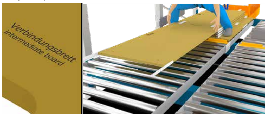
Illustration 34: Poser les planches de liaison
