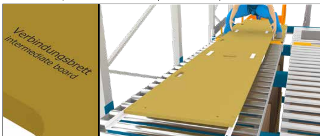
Illustration 35: Poser les planches de liaison
