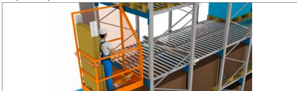
Illustration 41: Chariot élévateur sans prise latérale suffisante (< 150 mm dans toutes les directions) et nacelle élévatrice avec garde-corps.
