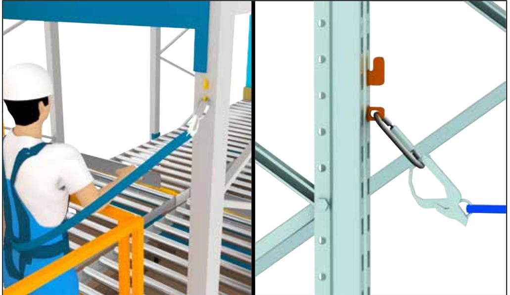
Abbildung 25: Sicherung mit BITO easyHook an Stütze
