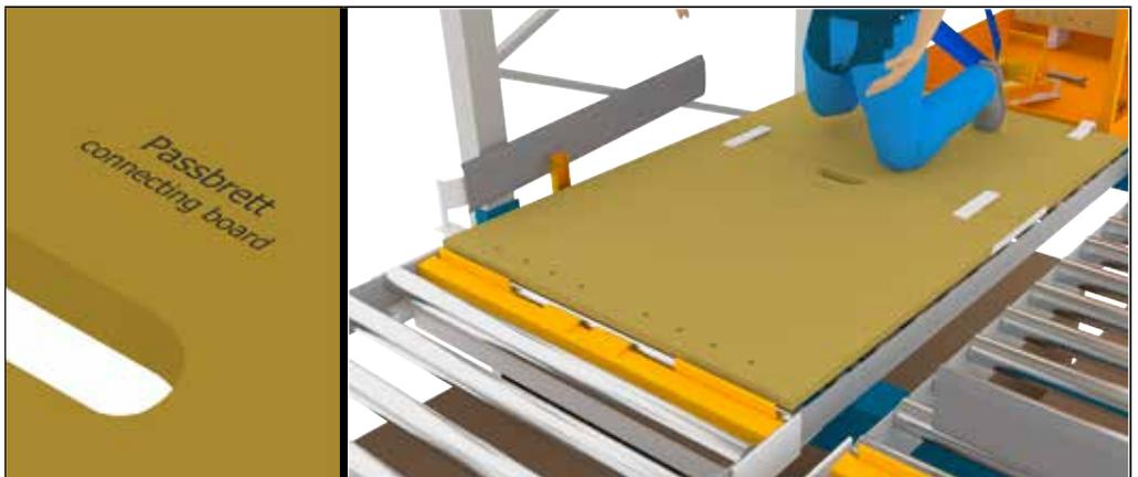
Abbildung 32: Verbindung des Passbretts an das Startbrett
