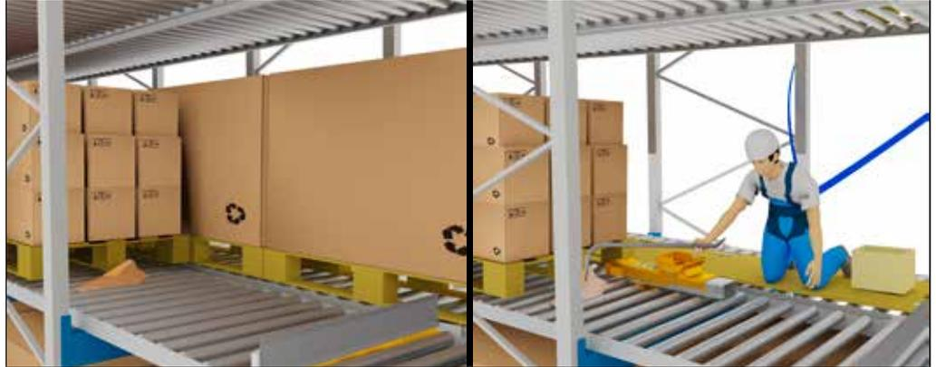
Abbildung 7: Entfernen von Gegenständen / Verpackungsresten im Kanal
