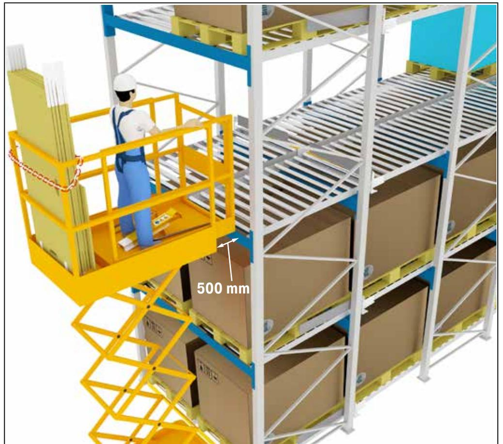
Abbildung 22: Scherenshubarbeitsbühne und weitere Arbeitsbühnen
