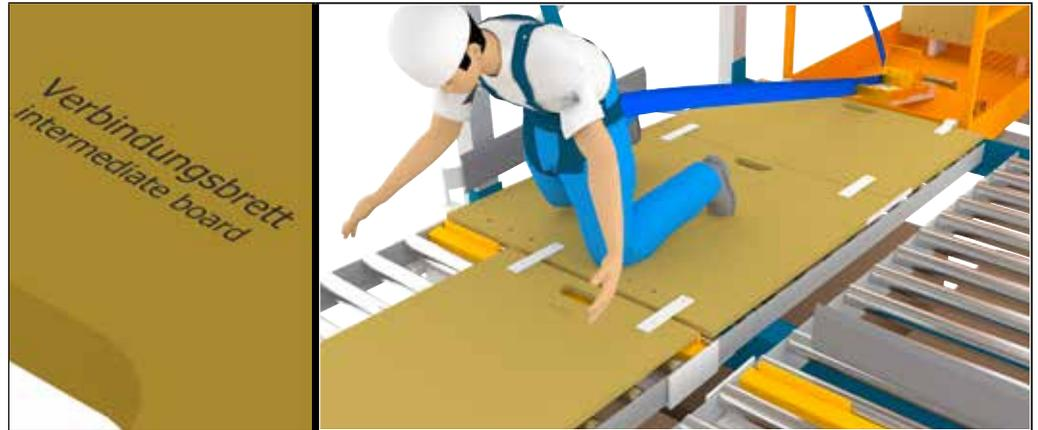
Abbildung 37: Verbindung des Verbindungsbretts an das Passbrett
