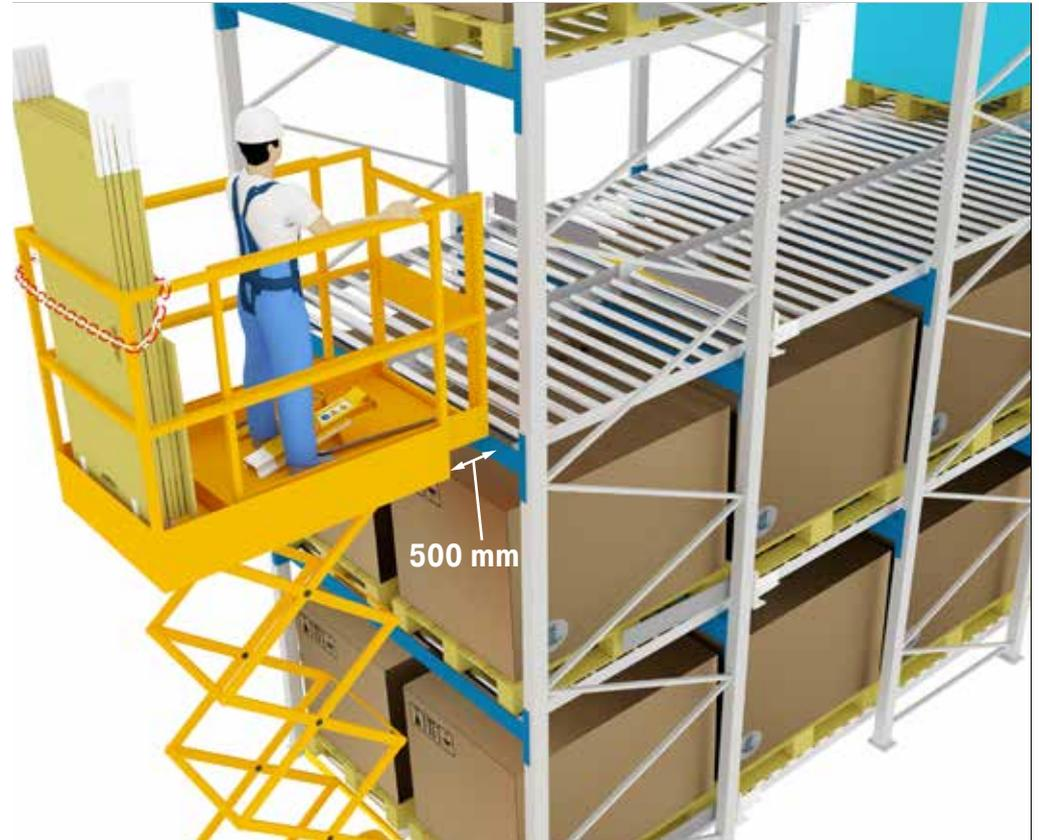
Abbildung 42: Scherenshubarbeitsbühne und weitere Arbeitsbühnen
