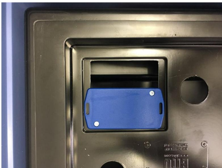
Abbildung 2 Position Messwertaufnehmer in Halterung für obere Kühlelemente
