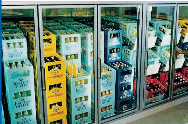
Abgeknickte Ebene zur Einzelflaschen-Kommissionierung sowie gerade Ebenen zur Entnahme ganzer Kästen
