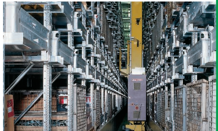
Automatisiertes Palettenregal im Einplatzstellsystem
