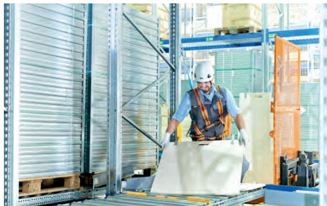
4. Legen Sie das Passbrett bis zum gelben Anschlag der Nachlaufsperre an
