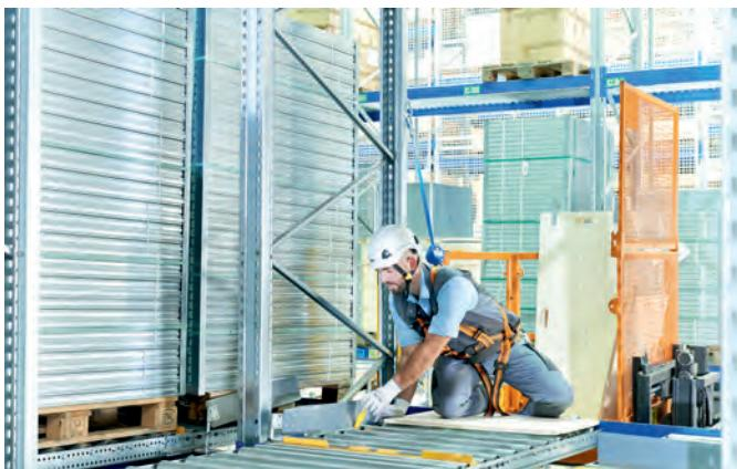
3. Schwenken Sie die FlowStop-Fahne und sichern Sie diese mit Hilfe der Klemmvorrichtung ab
